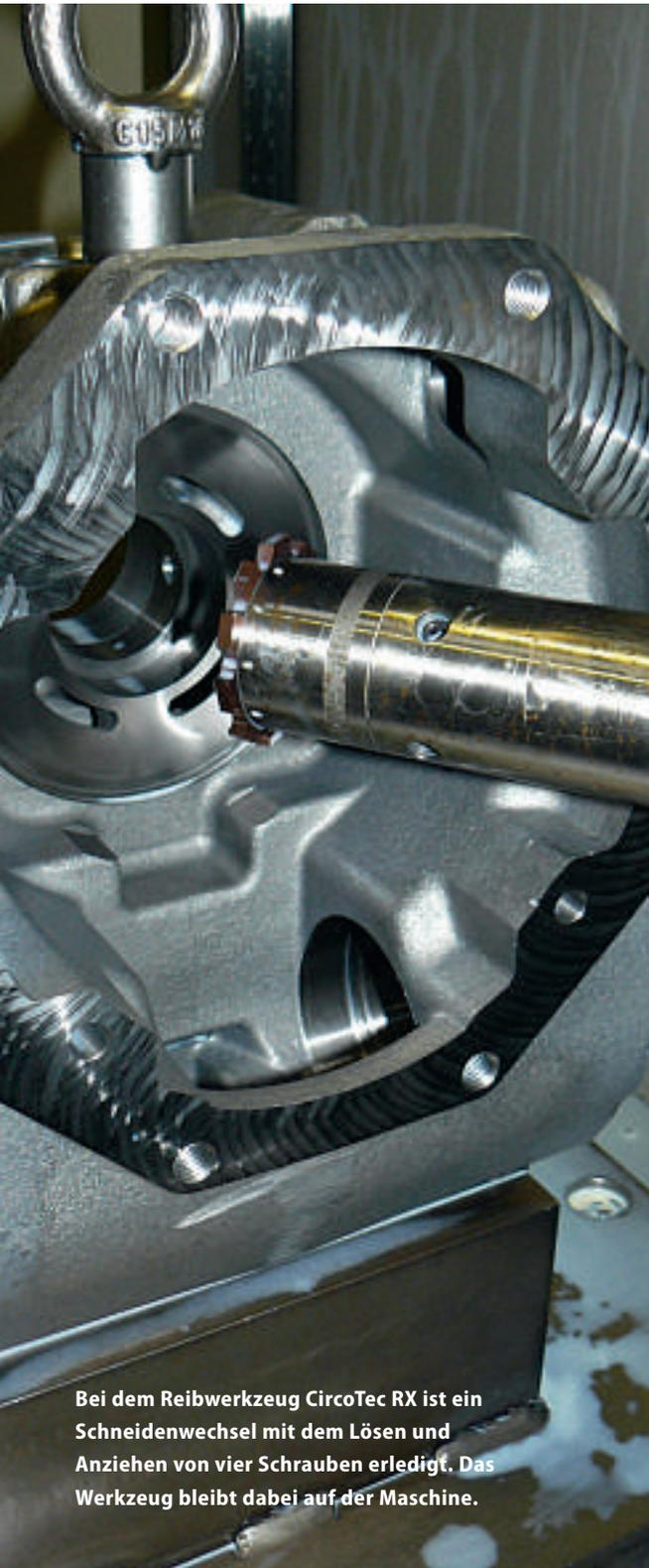
Präzises Reibwerkzeug von Urma ersetzt Ausspindelwerkzeug: Bei der Herstellung einer neuen Generation von Pumpengehäusen musste die Firma Lindenmann das Werkzeugsystem wechseln, um so die Präzision optimieren zu können. Mit dem Reibwerkzeug CircoTec RX von Urma liess sich die geforderte Oberflächengüte  $Ra = 0,8$  problemlos erreichen.
